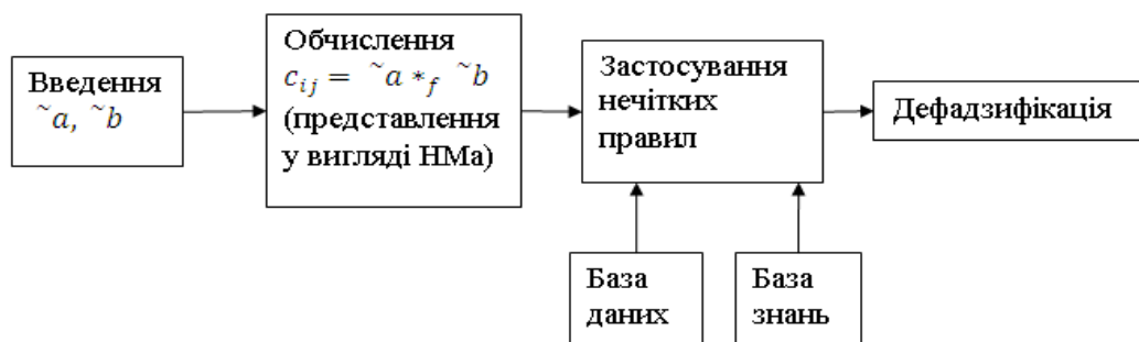
Рис. 2. Стандартна схема роботи в нечіткому логічному базисі.
