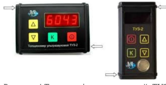
Рис. 2 Товщиномір Туз-2 із контрольним зразком
