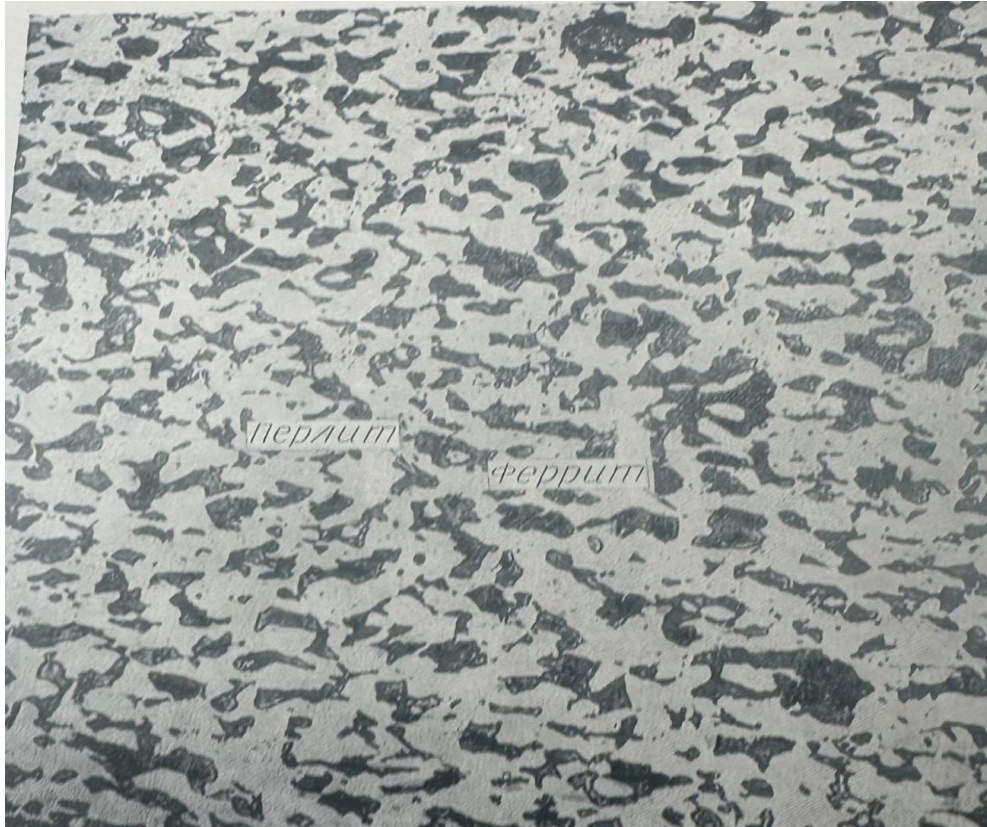
Рис. 1 Мікροструктура Сталі 20 в задовільному стані.
