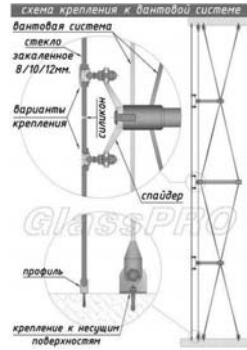
Рис. 3. Кріплення спайдера до вантової системи
