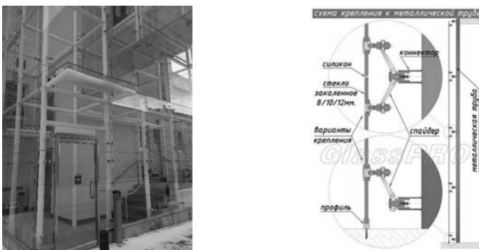
Рис.2. Кріплення спайдера до металевих колон
