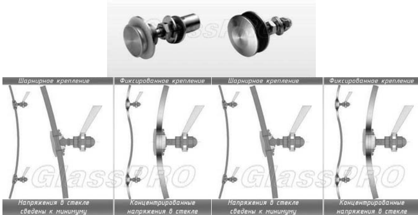
Рис. 5. Принцип роботи шарнірів у спайдерах
