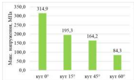
Рисунок 5. Графік залежності напружень в арматурі біля внутрішньої грані стіни від зміни кута атаки снаряду
