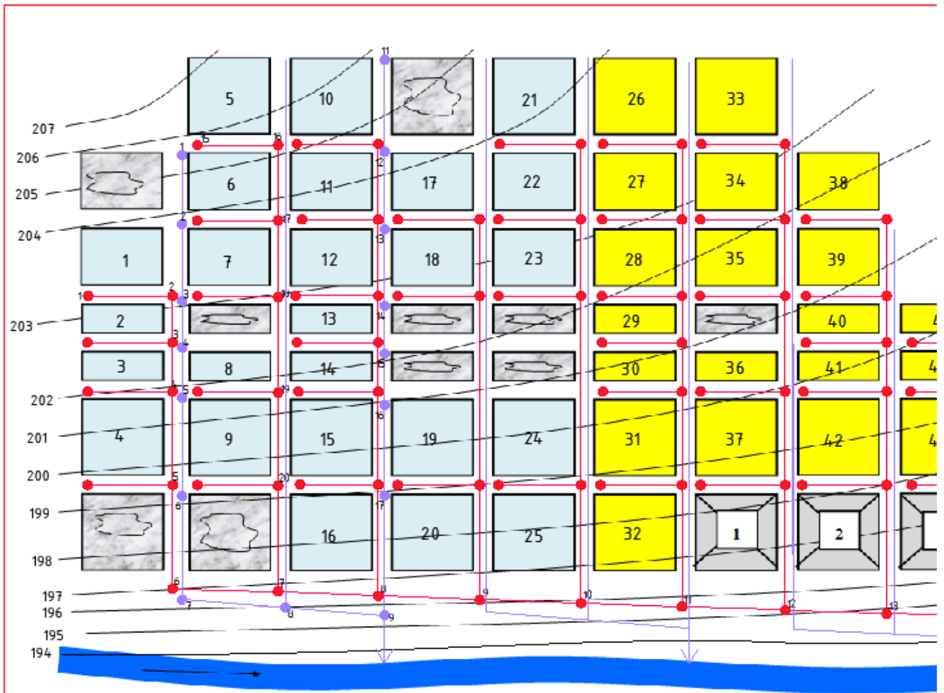
Рис.1.2. Трасування дощової мережі водовідведення
