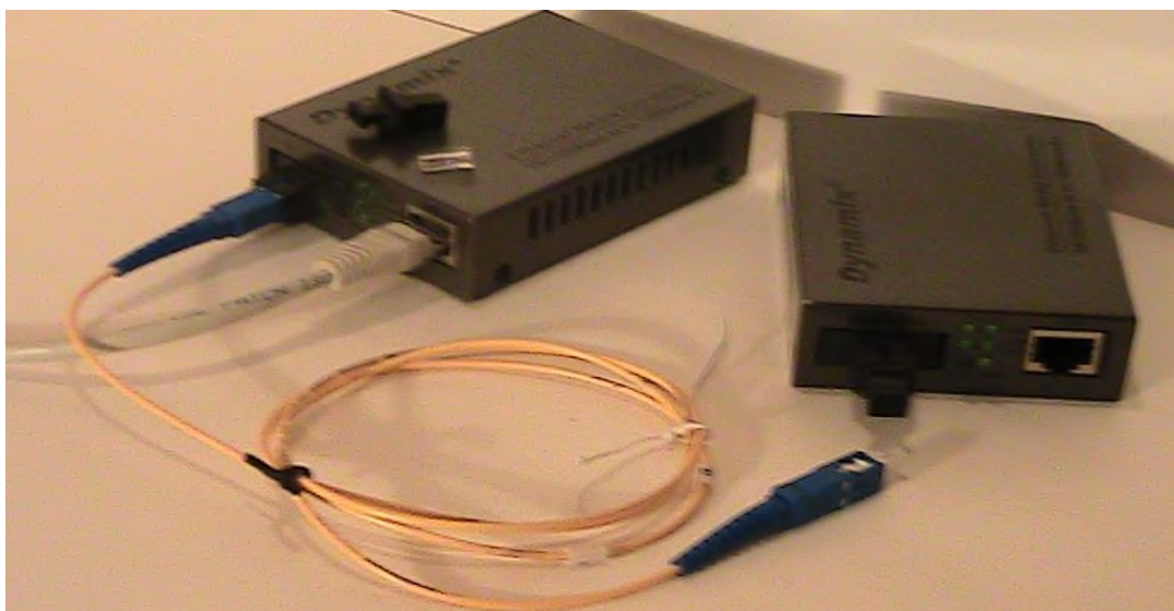
Рис. 9. Пара медіа конверторів, які забезпечують повний дуплекс по оптичному волокну довжиною до 20 км зі швидкістю 100 Мбіт/с (на лівому конверторі бачимо захисні ковпачки від гнізда і шнура)
