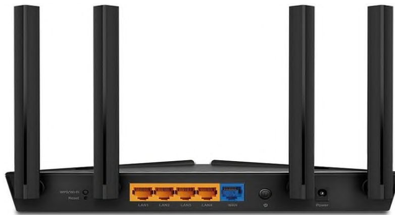
Рис. 10. Маршрутизатор з бездротовою точкою доступу за технологією WiFi: а) передня панель з індикаторами, б) задня панель з гніздами для шнурів
