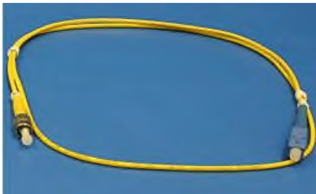
Рис. 5. Оптичний з'єднувальний шнур зі роз'єднувачами двох різних типів: ST – від англ. Straight Tip (ліворуч) та SC – Subscriber Connector (праворуч)
