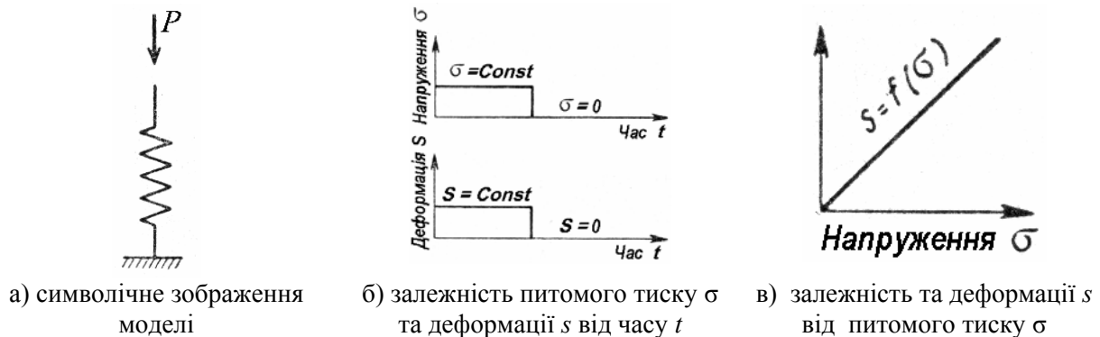
Рис. 1. Модель пружного тіла Гука
