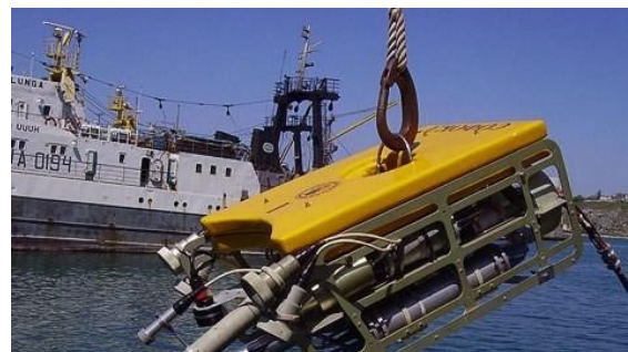
Рис. 5. Підводний апарат, підрулюючий комплекс якого організований за одновальною схемою
