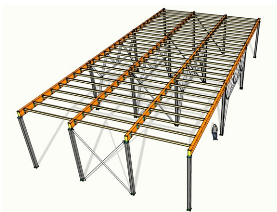
Рис. 1.2. Нормальна схема балкової клітки
