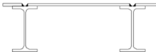
Рис. 1.6. Улаштування плоского металевого настилу по балкам
