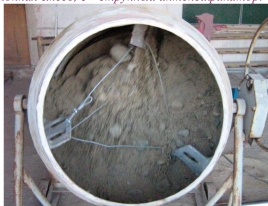
Рис. 2. Фото модернизированного гравитационного бетоносмесителя.
