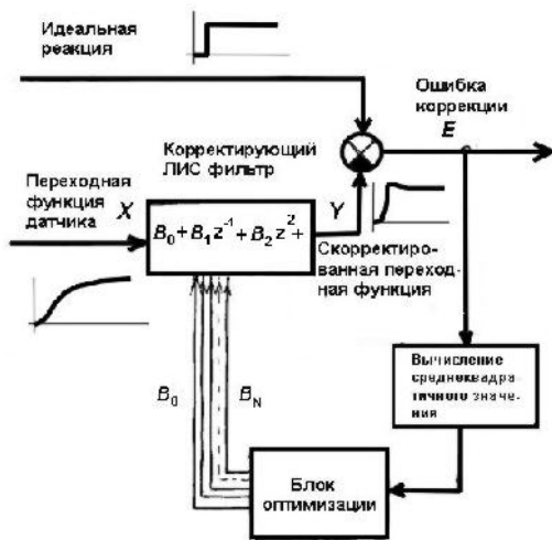
Рис. 1. Схема синтеза динамического корректора
