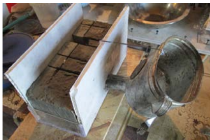
Рисунок 1. Пристрій для відновлення нижніх поверхонь бетонних зразків
