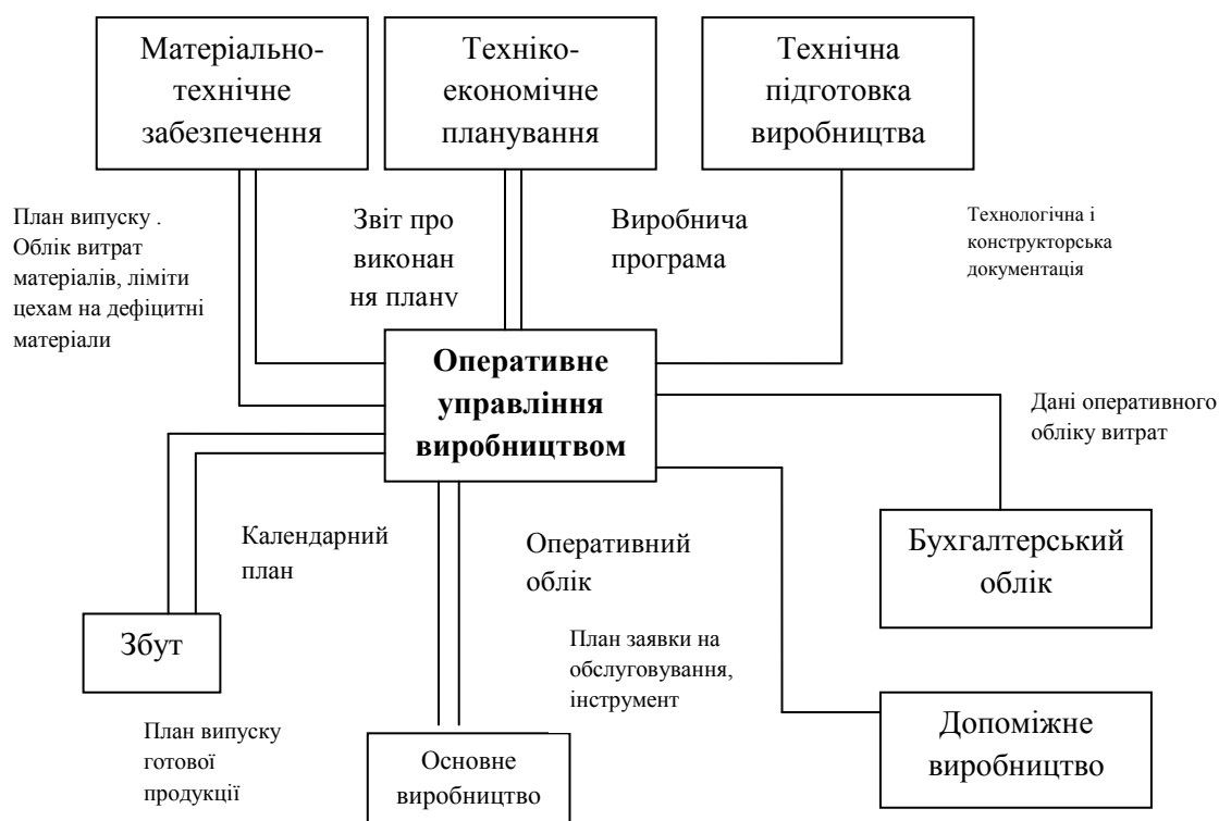
Рис.1.17. Укрупнена схема зв'язку служби оперативного управління виробництвом з іншими службами підприємства
