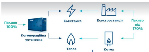
Рисунок 2. Комбіноване вироблення енергії та тепла
