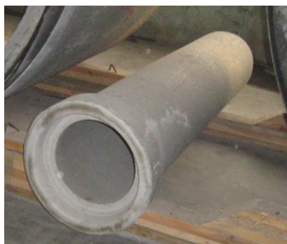
Рис. 1. Встановлення зовнішньої оболонки форми труби \varnothing 400 мм в установку вертикального вібропресування; сталевібробетонна труба \varnothing 400 мм, після набору міцності
