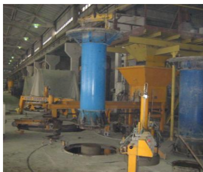
Рис. 1. Встановлення зовнішньої оболонки форми труби \varnothing 400 мм в установку вертикального вібропресування; сталевібробетонна труба \varnothing 400 мм, після набору міцності
