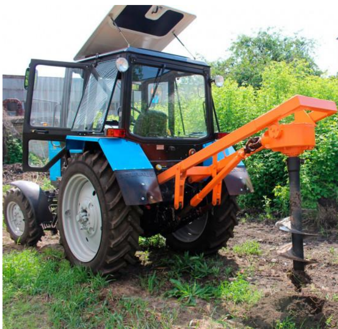
Рис 1.2 Навісне бурильне обладнання марки БАМ-1,3
