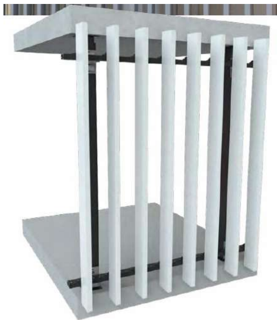
Рис. 6.2 Зображення конструкції фасадних вертикальних панелей
