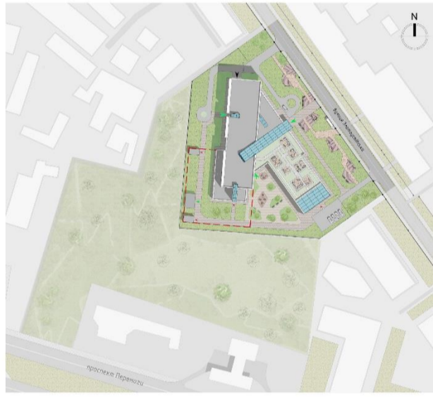
Генеральний план М1:500 Умовні позначення до генплану — Червоні лінії забудови — Відростки з водовідведенням — Декоративна плитка майданчиків — Асфальтоване покриття — Шар озеленення, трава — Огорожа території
