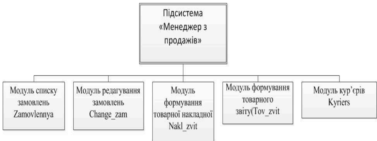
Рисунок 3.8 Структурна схема модулів підсистеми «Менеджер з продажів»
