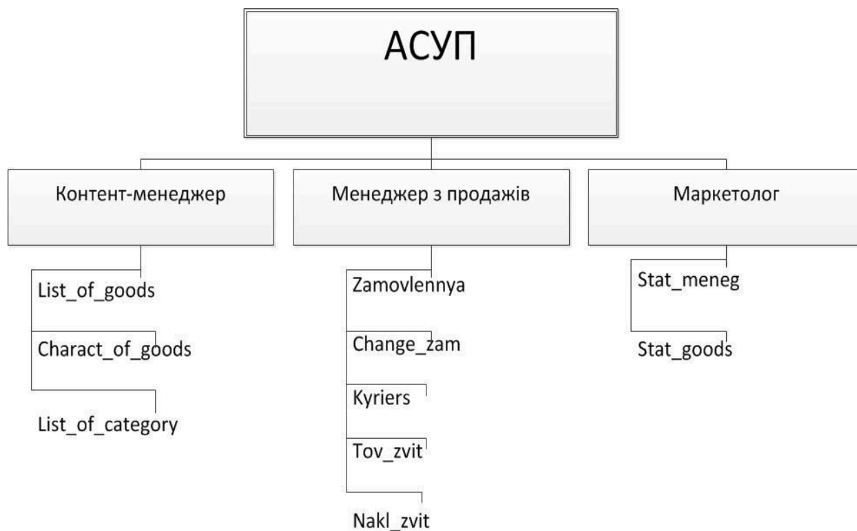
Рисунок 3.1 Структура програмного забезпечення АСУП
