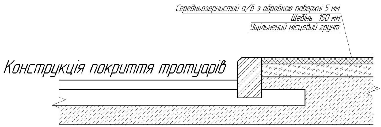
Рис. 4.14 Конструкція покриття тротуару
