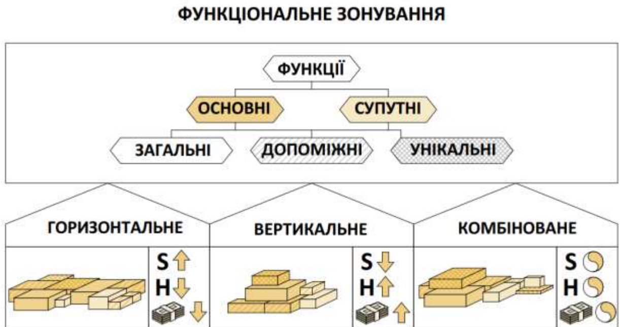
Рис. 2.1. Схема типів функцій та їх зонування в об'ємі споруди.
