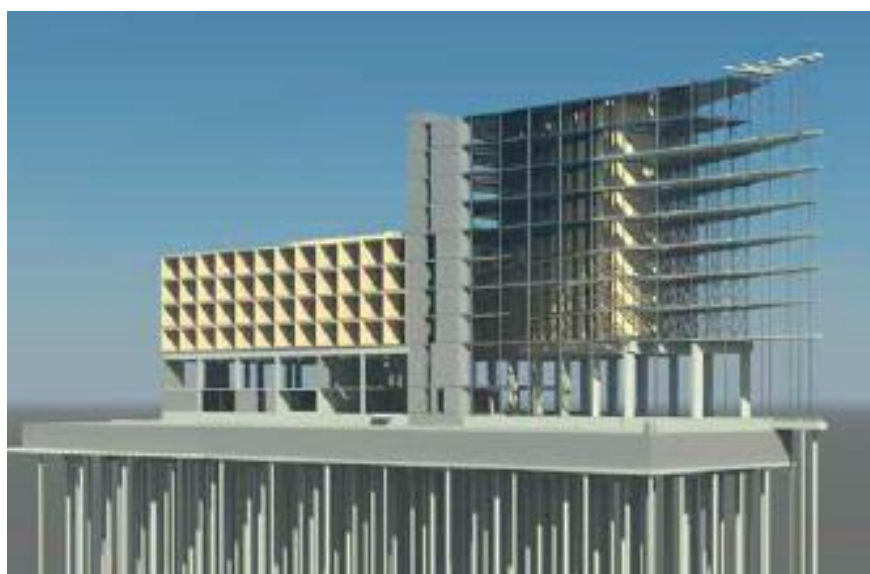
Рис. 2.15. Поєднання бетонних та дерев'яних конструкцій
