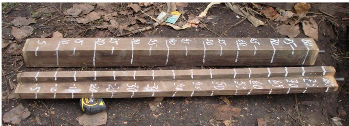
Рисунок 1. Моделі палі-штампів квадратного та таврового поперечного перерізу.
