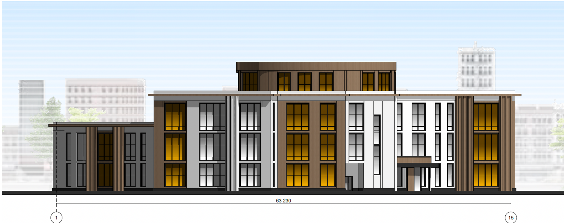
ФАСАД В ОСЯХ 1-15 М 1:100
