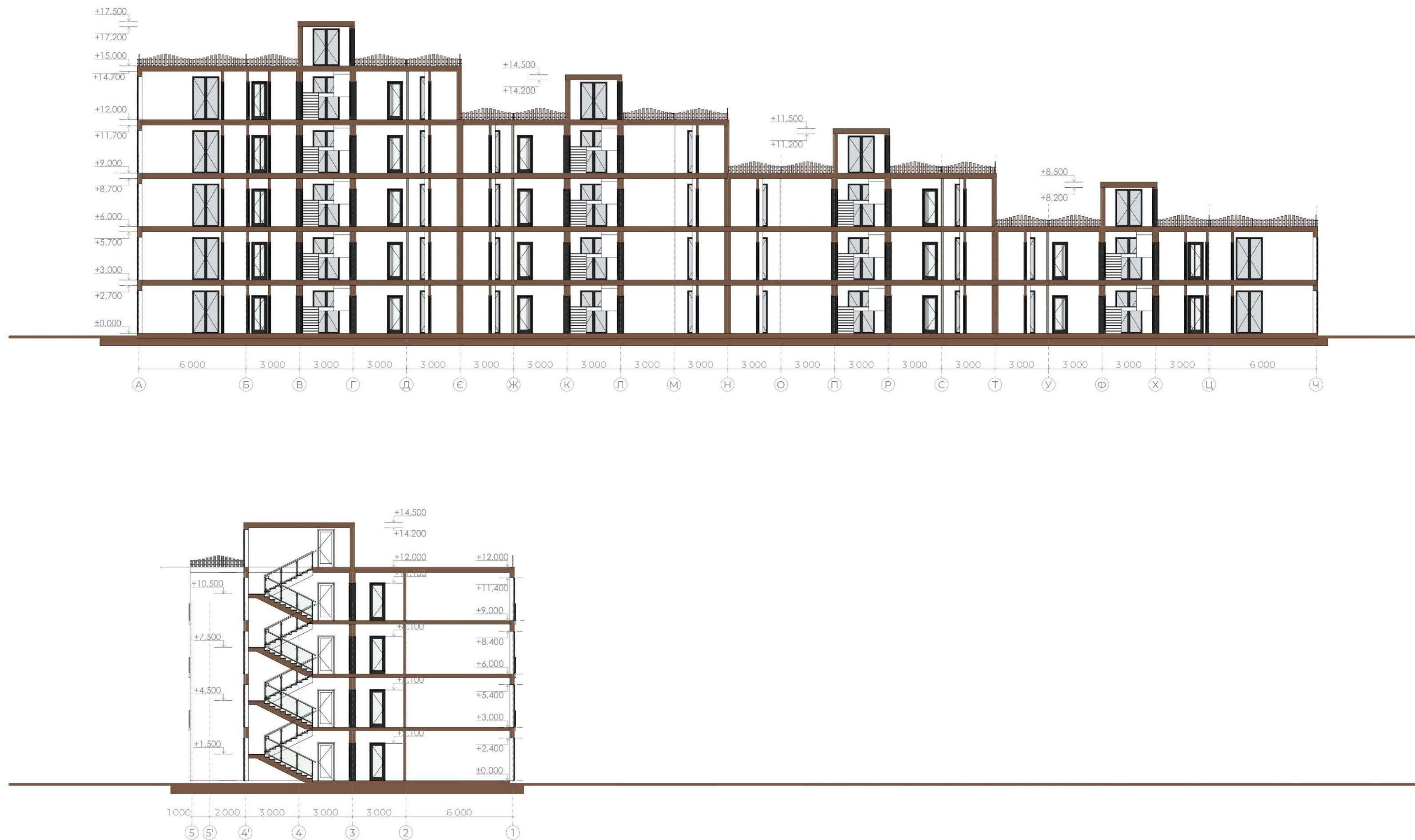
Рис. 334. Повздовжний та поперечний розрізи по типовому середньоповерховому будинку, М1:200
