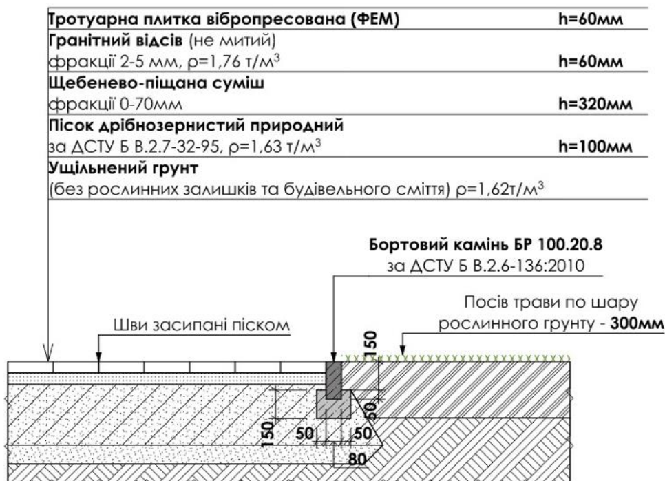
Рис. 21. Конструкція дорожнього одягу тротуарів
