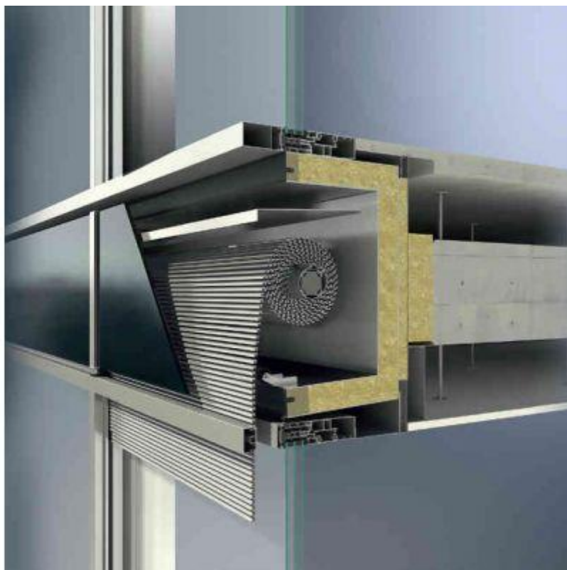
Рис. 5.3. Навісний сонцезахист Schüco CTB, вбудований в короб, що розміщується перед фасадом Schüco FWS 50 / FWS 60.
