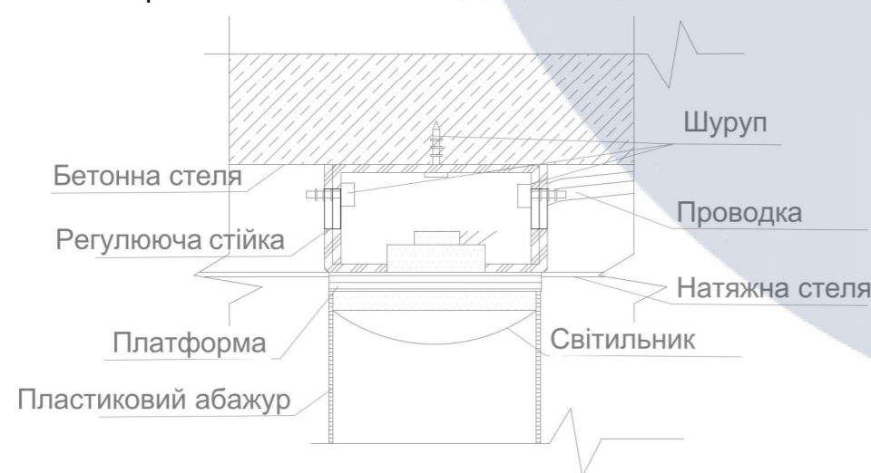
3. Кріплення лампи до стелі, М1:5
