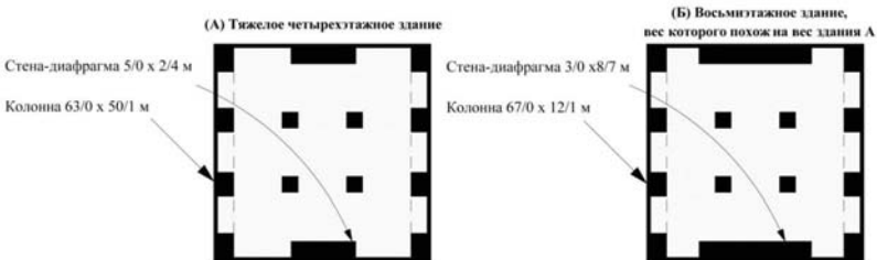
Рис.9. План цокольного этажа четырех- и восьмиэтажных зданий с одинаковым весом (система, выдерживающая тяжелые нагрузки, не показана, и рисунки изображены в одном масштабе).
