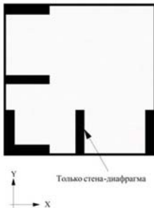
Рис.6. План цокольного этажа, который показывает сейсмостойкую конструкцию, имеющую симметричное построение относительно осей X и Y (система, выдерживающая тяжелые нагрузки, не показана).
