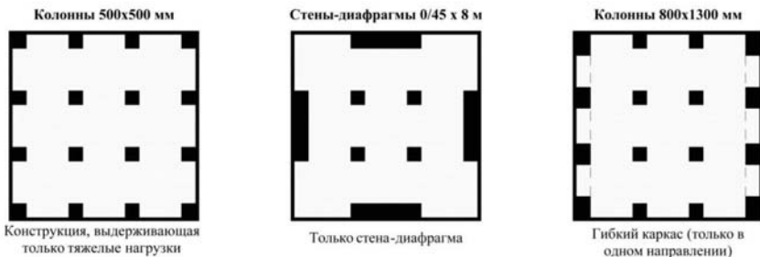
Рис.3.Планы цокольного этажа восьмиэтажных зданий, который показывает занятую поверхность конструкции вначале для системы, выдерживающей только тяжелые нагрузки, и в то время, когда стена-диафрагма или гибкий каркас выдерживают сейсмические силы (рисунки изображены в масштабе).
