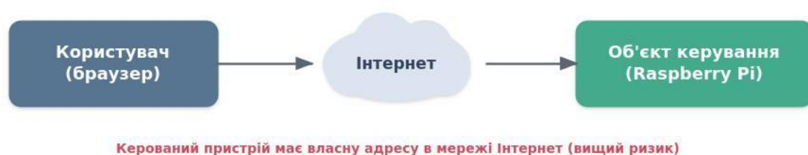
Рисунок 1.6 - Схема прямого керування об'єктами через загальнодоступну мережу
