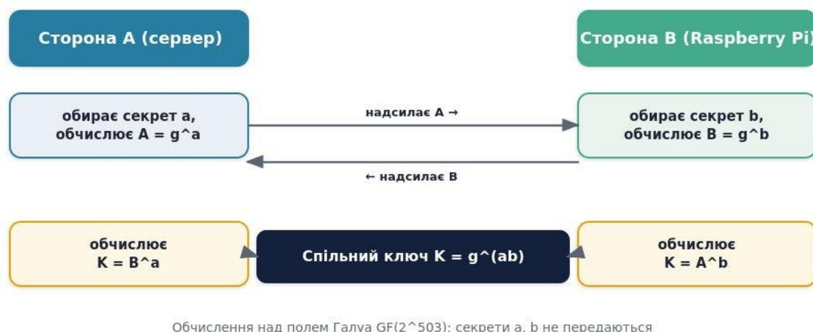
Рисунок 2.9 - Схема узгодження спільного ключа за алгоритмом Діффі-Геллмана
