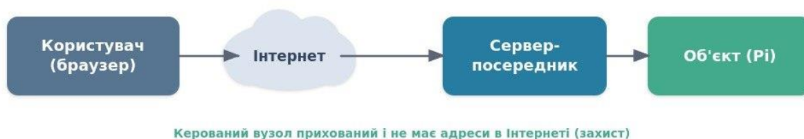
Рисунок 1.7 - Схема керування об'єктами з використанням сервера-посередника
