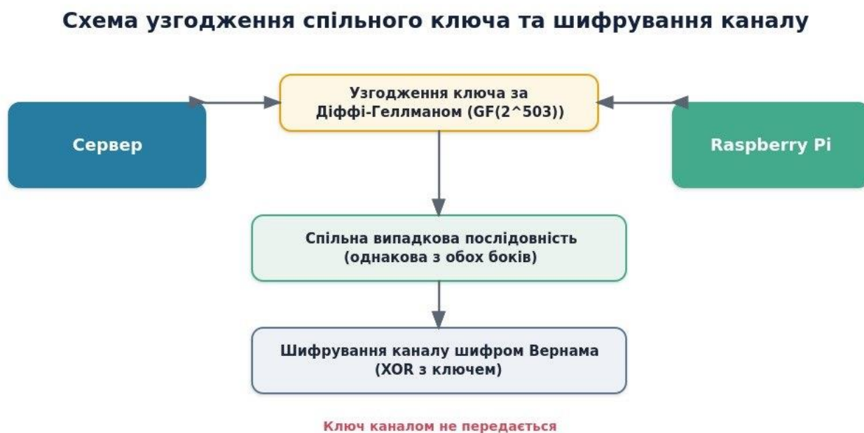
Рисунок 2.6 - Схема узгодження спільного ключа та шифрування каналу
