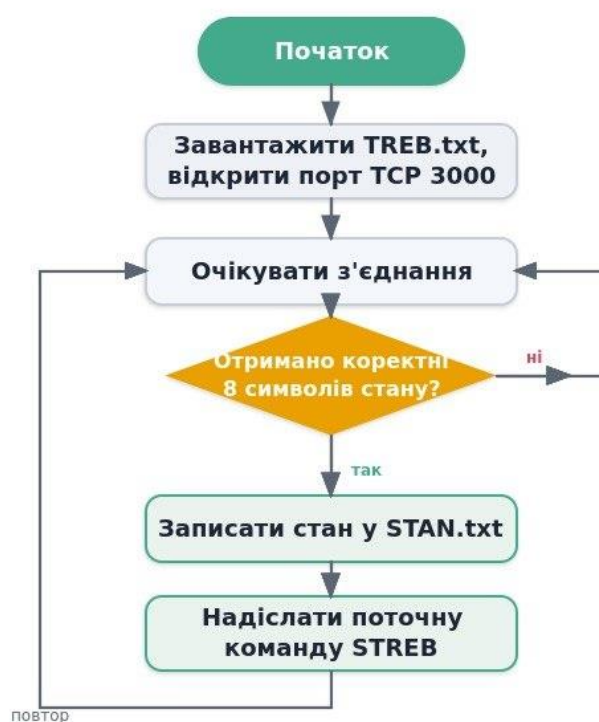
Рисунок 2.3 - Алгоритм роботи сервісу SOCKET.js
