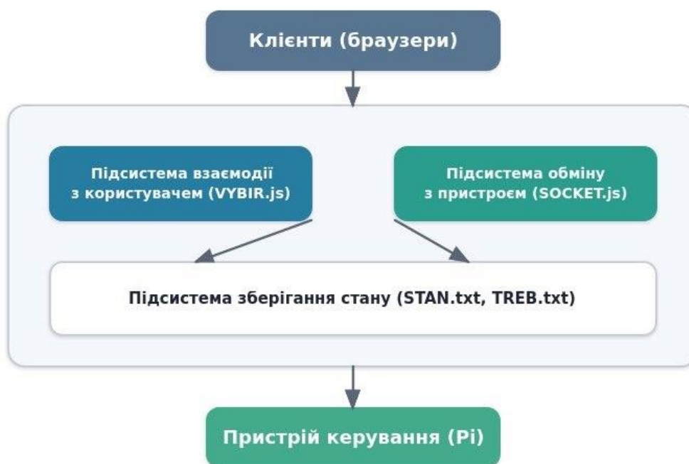
Рисунок 2.10 - Структурна схема серверної частини системи
