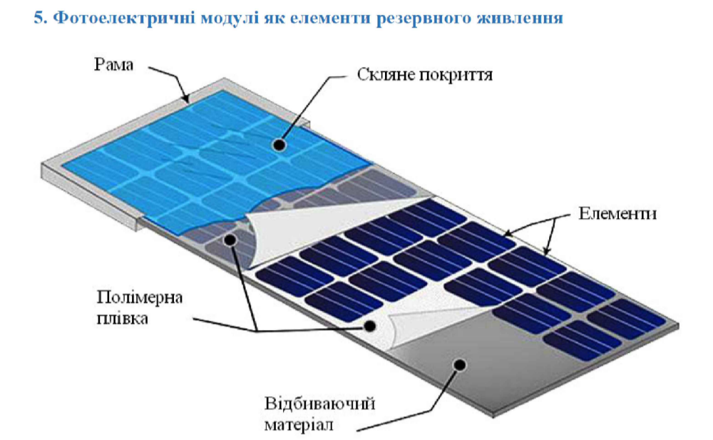
Рис. Конструктивне вирішення фотоелектричного модуля
