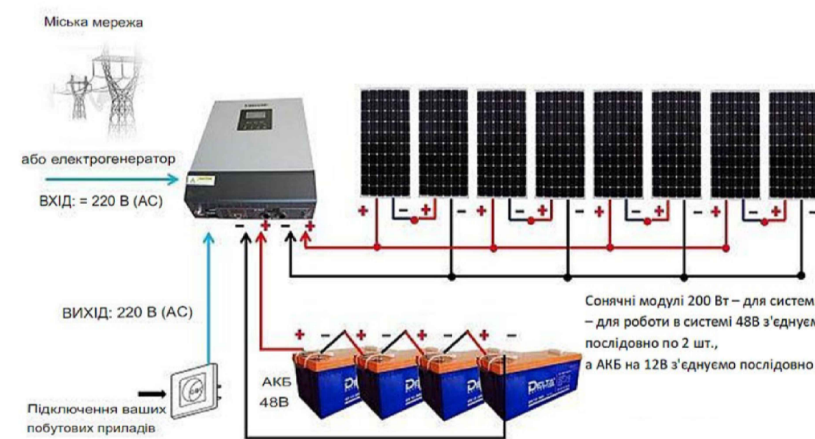
Рис. Фотоелектричний модуль з інвертором та акумуляторними батареями
