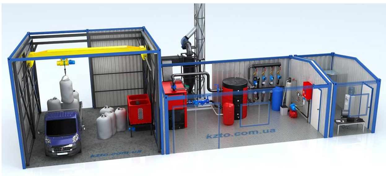
Рис.1.2 Зовнішній вигляд модульної котельні на твердому паливі
