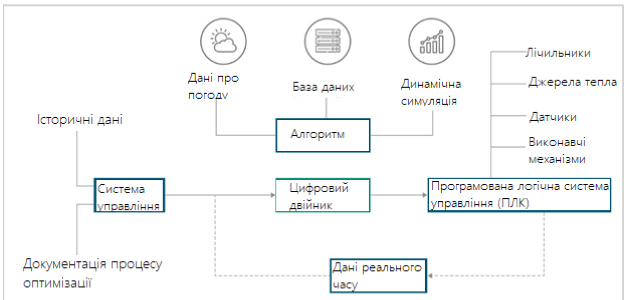
Рис.2.6 Ескіз концепції: Оптимізація процесів систем теплогенерації
