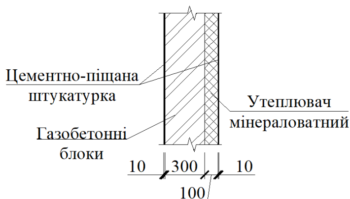
Рис.1 Конструкція зовнішньої стіни
