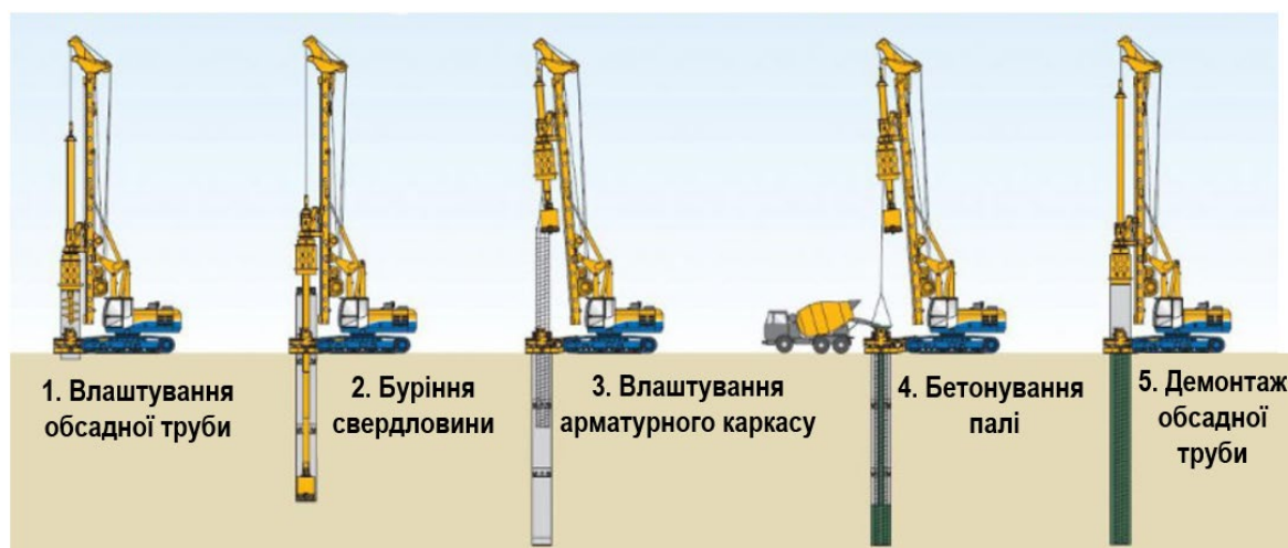
Рис. 5.1. Послідовність влаштування буронабивної палі.
