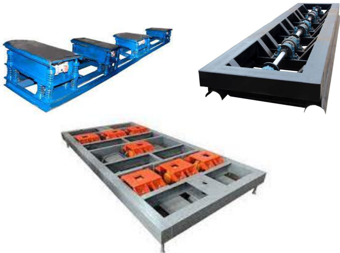
Рис. 1.2 Загальний вигляд віброплощадок для формування плитних конструкцій
