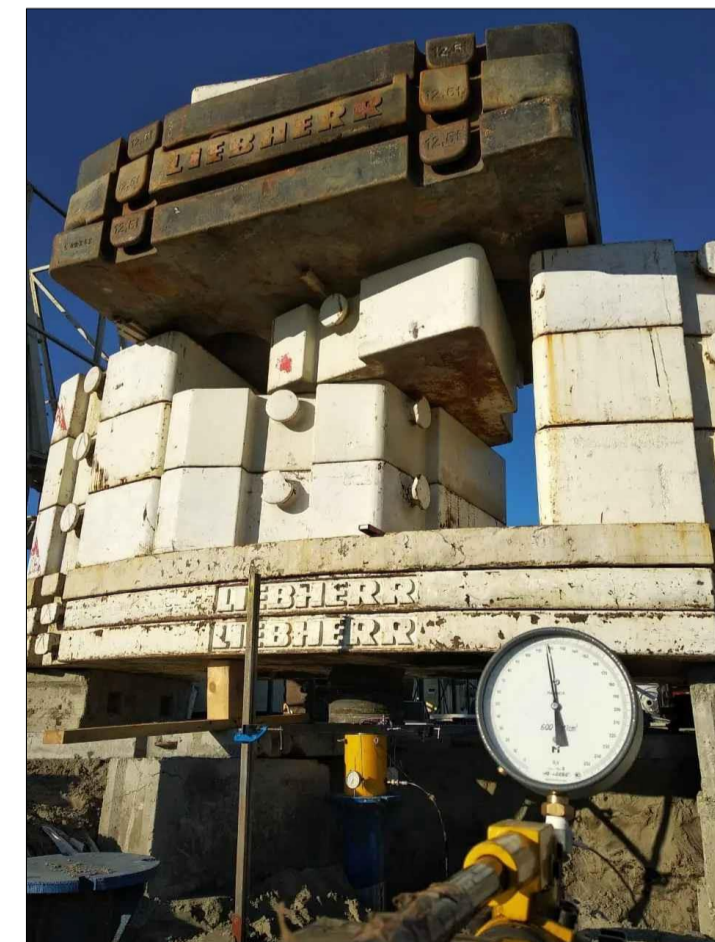
Рис.6 Установка з вантажною платформою, яка є опором для гідравлічного домкрата
