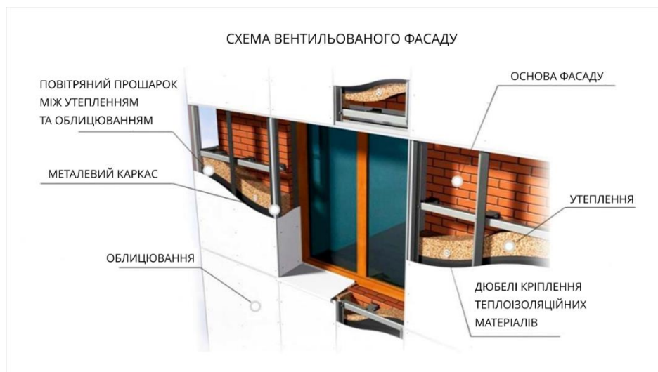
Рис. 6.5. Схема вентильованого фасаду [28]
