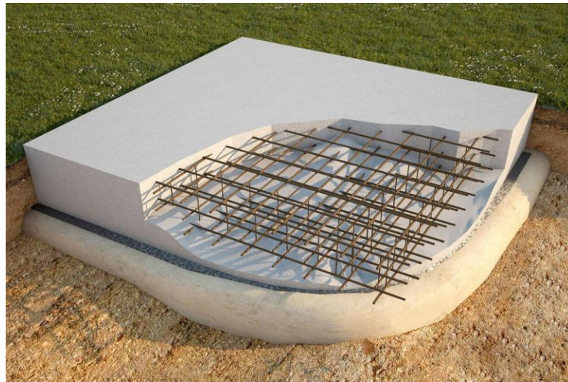
Рис. 6.2. Схема укладання монолітної фундаментної плити [20]
