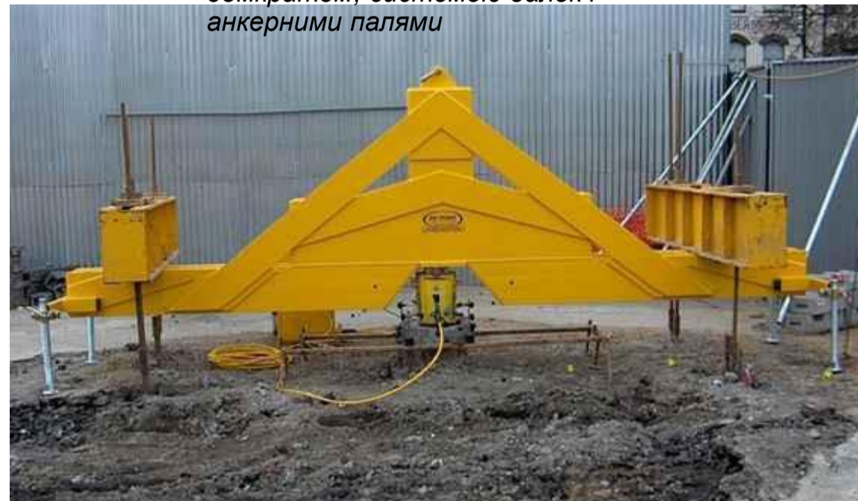
Схема установки з гідравлічним домкратом, системою балок і анкерними паллями
