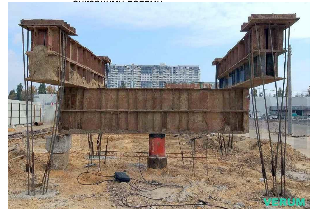
Установка з гідравлічним домкратом, системою балок і анкерними паллями
