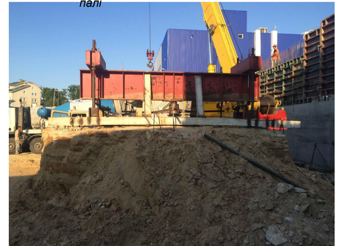
Установка з гідравлічним домкратом, системою балок і анкерними паллями
