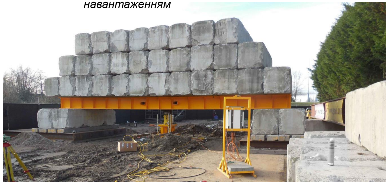
Установка з вантажною платформою для випробовування палі статичним навантаженням
