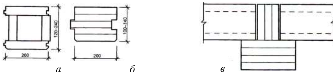
Рис. 97. Балкові дерев'яні клеєні елементи перекриттів: а – коробчастого перерізу; б – суцільного перерізу; в – спираєння на головну балку або ригель
