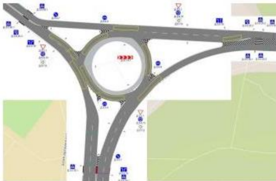
Рисунок 4. Модель проектованої схеми організації дорожнього руху на досліджуваному перехресті вулиць у програмному середовищі PTV Vissim
