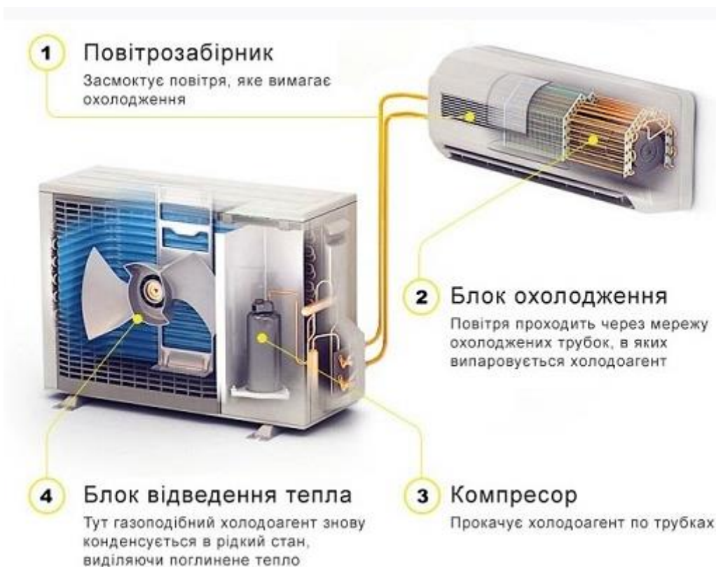
Рис.7.1 Приклад роботи спліт-системи
