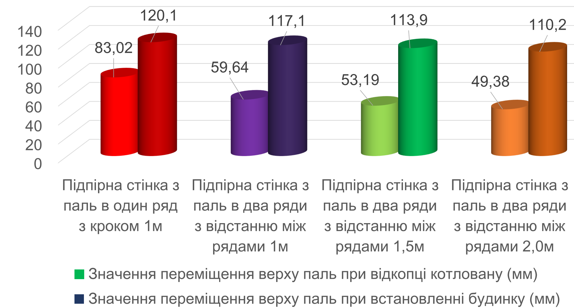
Порівняльні значення переміщення верху паль на різних етапах застосування при різних варіантах утримуючих конструкцій
