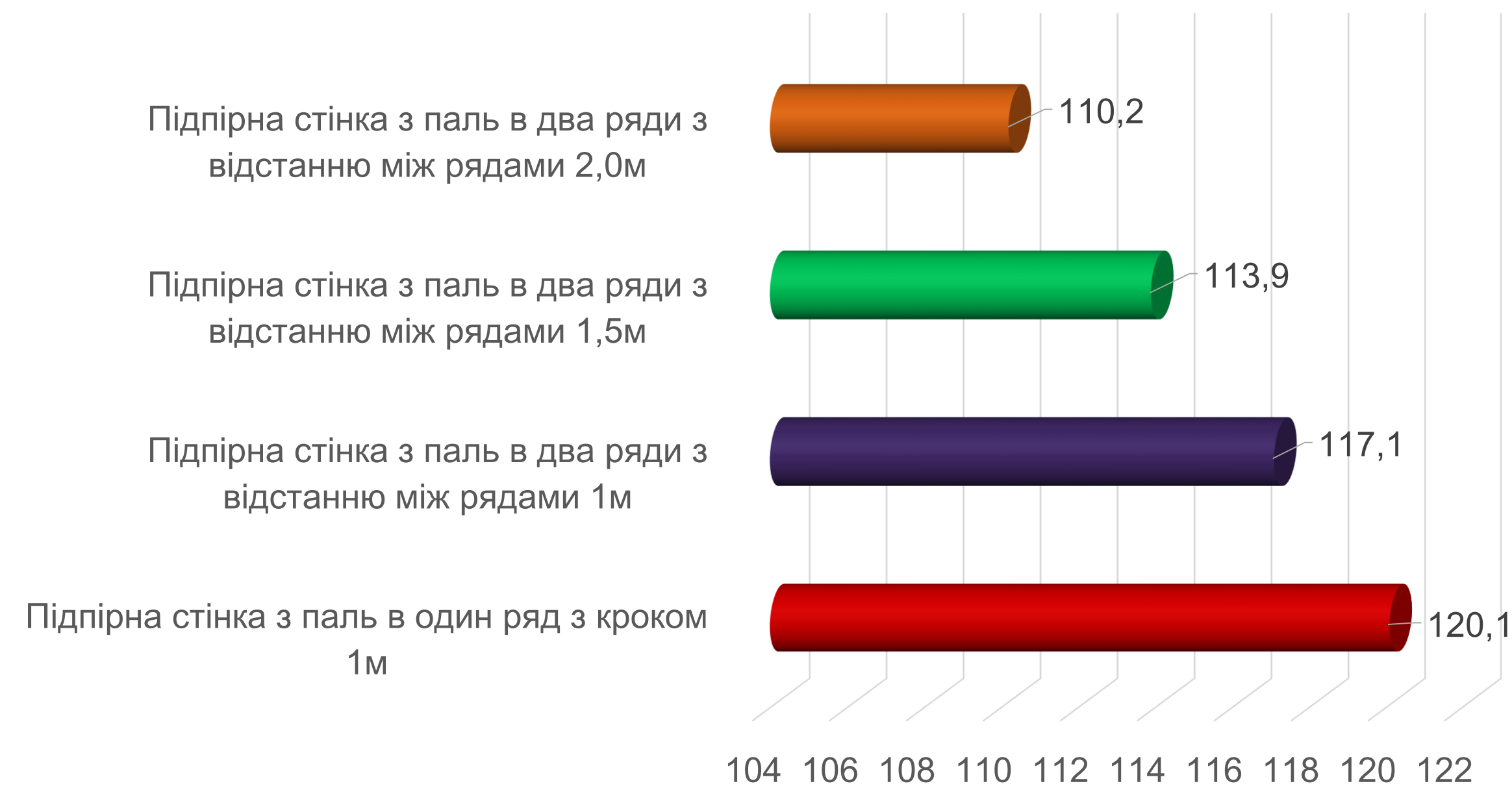
Значення переміщення верху паль при встановленні будинку при різних варіантах утримуючих конструкцій, (мм)
