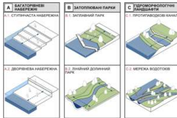
Рис. 1.1.1.1 Прийоми планувальної організації багаторівневих набережних, затоплених парків та гідроморфологічних ландшафтів за В.А. В'язовською [5]
