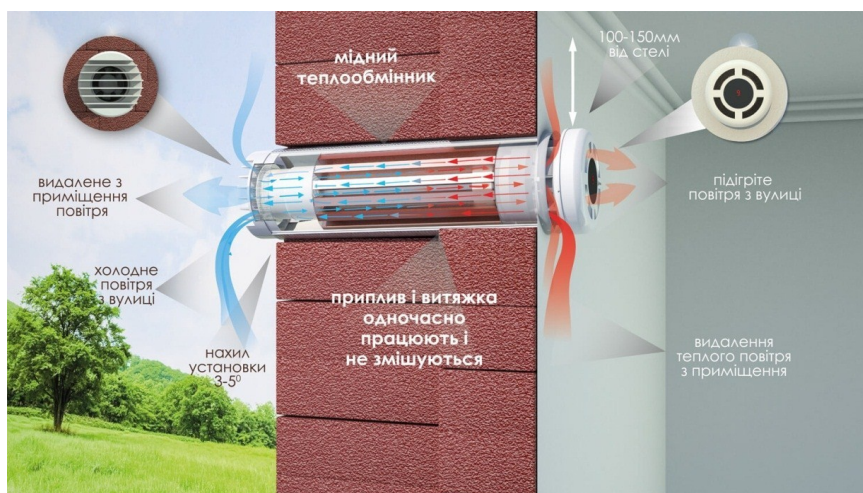
Рис.3.18 Схема роботи рекуператора повітря
