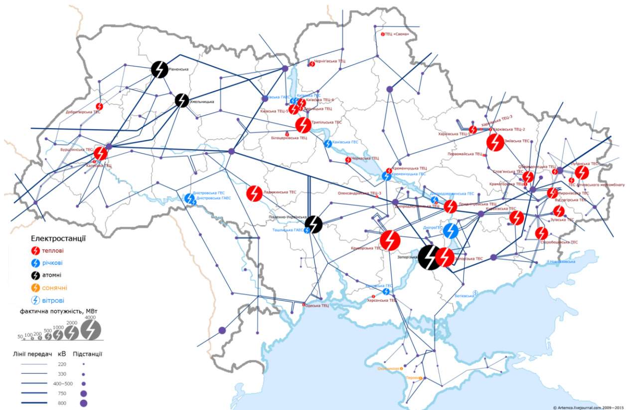
Рис. 1.2.1. Концептуальна схема розміщення основних енерговузлів генерації та транспорту України (станом на 2010 рік)
