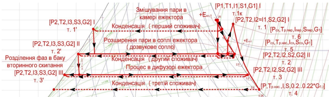
Рис. 0.8.2. Фрагмент TS-діаграми води та водяної пари. Характерні термодинамічні процеси послідовної схеми паропостачання промислового підприємства з використанням динамічного потенціалу перегрітої пари вторинного скипання
