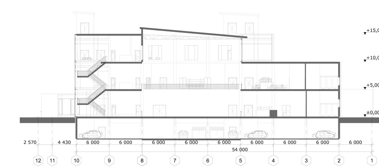
Розріз 2-2 в осях 10-1, М 1:200
