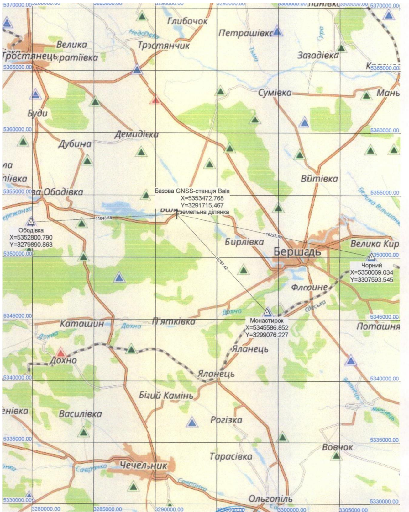
Рис.2.4 Схема ГНСС спостережень з прив'язкою до пунктів державної геодезичної мережі
