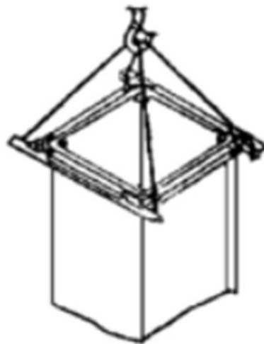
Рис. 4.2. Стропування вертикального повітровода
