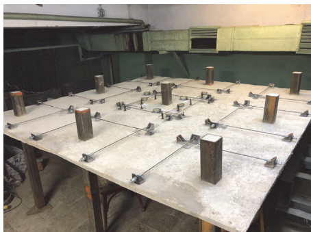
Рис.1 - Загальний вигляд залізобетонної плити підсиленої зовнішньо напруженою арматурою
