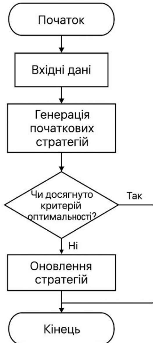
Рисунок 2.4 – Блок-схема алгоритму оптимізації стратегії гри
