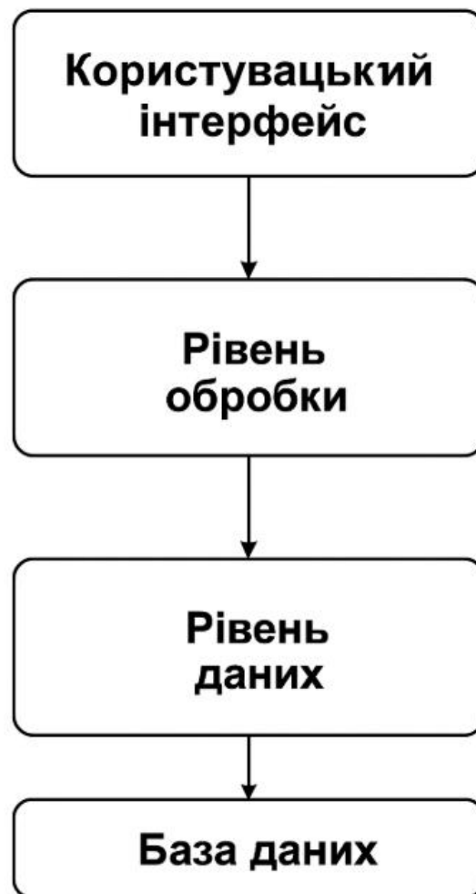
Рисунок 2.3 – Блок-схема загальної архітектури ПЗ
