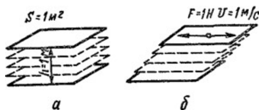
Рис. 2. Схема взаємного переміщення прошарків рідини: а – стан спокою; б – початок руху
